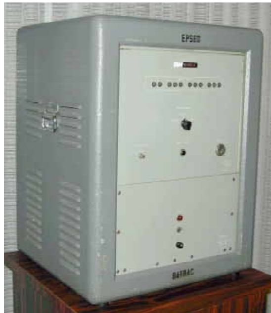
图5: 1954年EPSCO公司Bernard M. Gordon设计的11位、50-kSPS SAR ADC "DATRAC"
