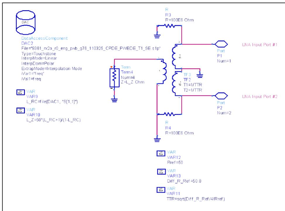
Figure 16. LNA Model Example
